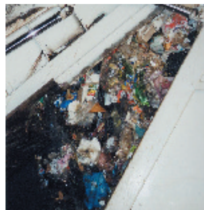
Un camión de cinco toneladas comprime la basura para optimizar su capacidad.
