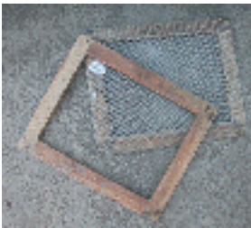
Paso 6 Bastidor anverso Bastidor reverso Contramarco Las medidas sugeridas son 30 x 15 centímetros.
